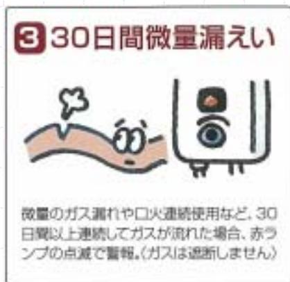
内管漏えい検知機能は、微量漏れを早期に発見することで保安レベルを向上させる機能であり、又法定漏えい検査の省力化等への配慮がなされている。
