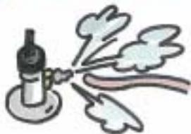
ゴム管はすれやガス栓開放など、ガスメーターの能力により定められた流量を超えてガスが流れると、赤ランプが点滅してガスを遮断。
