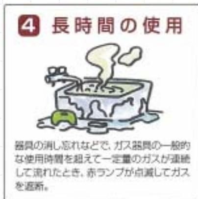
本機能はマイコンメーターを流れるガスの流量変化(個別流量)をとらえて、タイマーをスタートさせ、その個別流量が属する区分ごとに決められた設定時間を超えたとき、生ガス漏えい 又はガス機器の消し忘れと判断し、遮断する。
