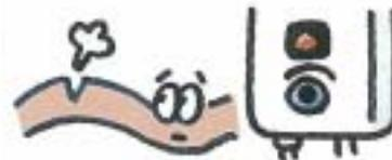
微量のガス漏れや口火連続使用など、30日間以上連続してガスが流れた場合、赤ランプの点滅で警報。(ガスは遮断しません)
