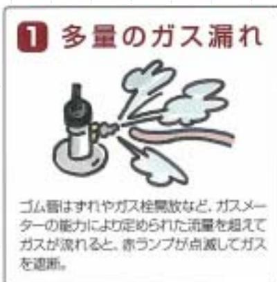
通常の機器使用では起こり得ない異常なガス流量があった場合、ガス漏れと判断しガスを遮断することにより、ガスの大量漏れによる爆発事故の防止を図る。
