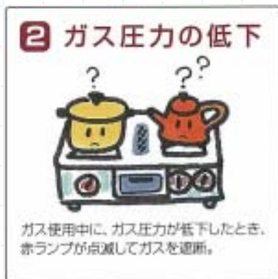
マイコンメータは、供給圧力の異常低下に伴う機器使用中の失火による生ガス流出を防止する目的で、常時、供給圧力を監視している。
