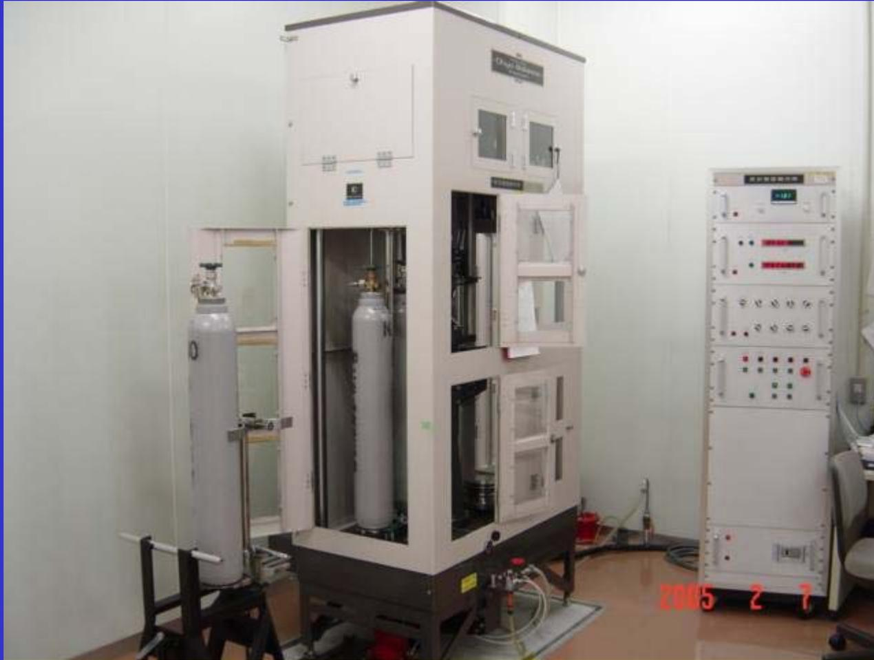
特定標準ガスは、質量比混合法により小さな不確かさで製造されています
